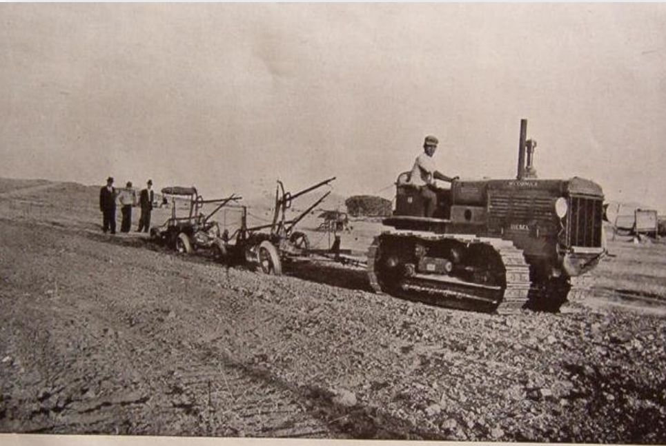
Eskişehirde, Drayfarming Örnek Çiftliğinde nadas hafriyatı (Orta Anadolu ziraatinde ancak 5.000 dönümlük bir çiftlik traktörü rentabl olarak kullanılabilir. 50 beygir kuvvetinde olan bu traktör günde 15 saat çalışarak 100 dönüm nadas çıkarır.)
